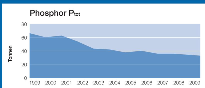
Phosphor fördert wesentlich das unerwünschte Algenwachstum in Seen. Bis auf einzelne kleine Anlagen, die nicht im Einzugsgebiet eines Sees liegen, müssen alle ARA Phosphor in Form von Phosphat aus dem Abwasser eliminieren. Diese ARA verfügen neben der mechanischen und biologischen Reinigung zusätzlich über eine Phosphatfällung.
